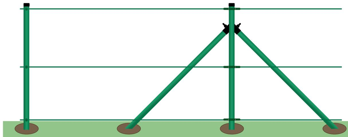
Jestliže potřebujeme přichytit napínák z dvou stran sloupku (např. na rohový či průběžný sloupek) použijeme dvě očka na přichycení napínáku, které navlečeme na opasek.
