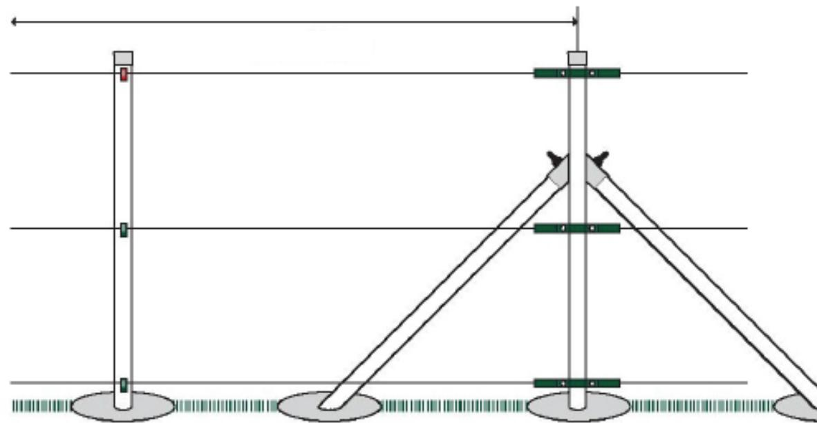
Jestliže potřebujeme přichytit napínák z dvou stran sloupu (např. na rohový či průběžný sloupek) použijeme dvě očka na přichycení napínáku, které navlečeme na opasek.
