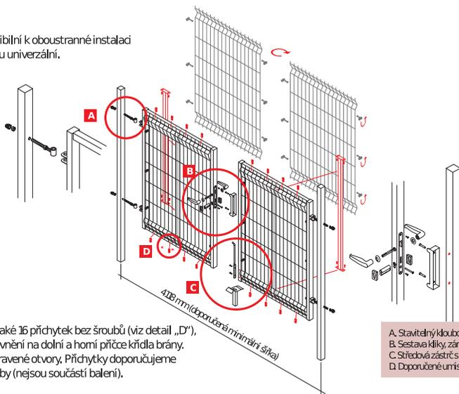
\* Příslušenství brány obsahuje také 16 příchytek bez šroubů (viz detail „D“), které slouží k případnému zpevnění na dolní a horní příčce křídla brány. Horní a dolní příčka nemá připravené otvory. Příchytky doporučujeme připevnit samozávrtnými šrouby (nejsou součástí balení).
