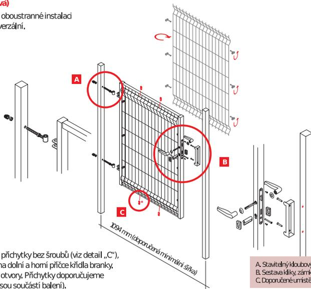
\* Příslušenství branky obsahuje také 4 příchytky bez šroubů (viz detail „C“), které slouží k případnému zpevnění na dolní a horní příčce křídla branky. Horní a dolní příčka nemá připravené otvory. Příchytky doporučujeme připevnit samozávrtnými šrouby (nejsou součástí balení).
